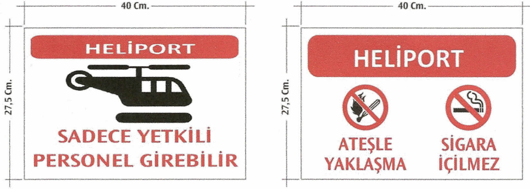
Şekil 4-1. Heliport Uyarıcı/Önleyici Levhalar (Örnek)
