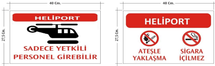
Şekil 4-1. Heliport Uyarıcı/Önleyici Levhalar (Örnek)
